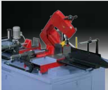
MOD. 370 A DS CNC Rotazione manuale Manual bow rotation
